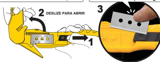
※Quando a lâmina perder o corte, mova-a de uma posição para outra; uma lâmina reversível SKB-10 fornece 4 pontos de corte.
